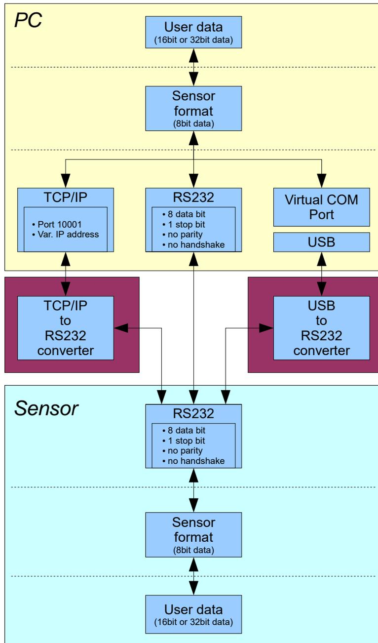
Für alle physikalischen Varianten der Verbindung zwischen PC Software und Kontrollelektronik gleichermaßen wird ein proprietäres Protokollformat verwendet, das die gewünschten Daten organisiert und bündelt. Die Nutzdaten sind abhängig von ihrer Art und Funktion 16- oder 32bit Variablen und repräsentieren Ganzzahl oder Gleitkommawerte. Die Bestandteile des Protokollformats sind 8bit weite vorzeichenlose Worte („bytes“). Dadurch müssen Nutzdaten zum Teil auf mehrere Bytes verteilt werden.
