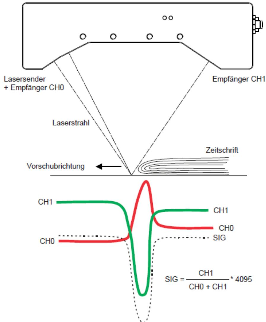
Das ausgewertete Signal kann über einen Spannungsausgang oder über einen Stromausgang ausgegeben werden. Mit Hilfe der Software können verschiedene Auswertemodi für das Analogsignal gewählt werden.
