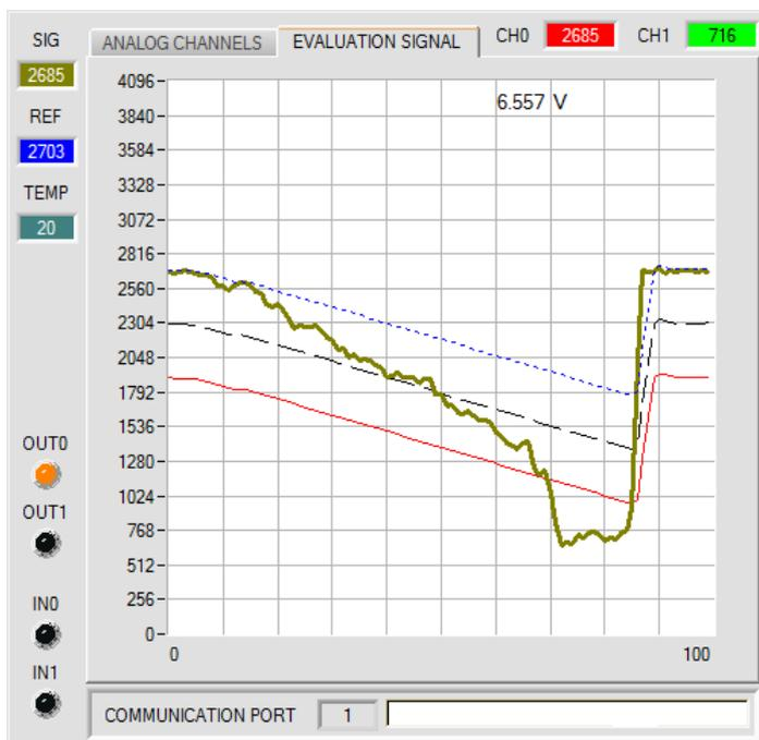
Im Beispiel wurde für **TT DOWN** ein Wert von 50 gewählt. Das bedeutet, dass die Schwellennachführung nach unten relativ langsam durchgeführt wird. In der Graphik kann man das an der blauen Referenzlinie deutlich sehen.
